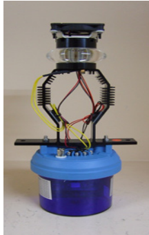
그림 10. 해상용 LED 등명기 본체 Fig. 10 Main Structure for LED marine lantern
