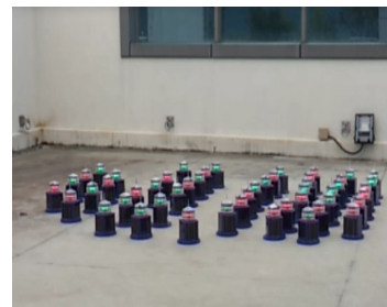
그림 13. 등명기들의 동기 점멸 동작 상태 Fig. 13 The synchronous flashing state of marine lanterns
