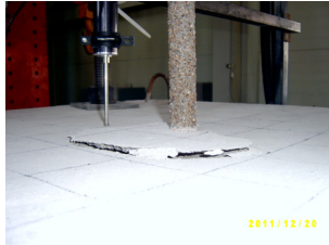
[그림 14] 인발시험 종료 후 균열 및 파괴 형상 [Fig. 14] Crack and failure shape after pull-out test
