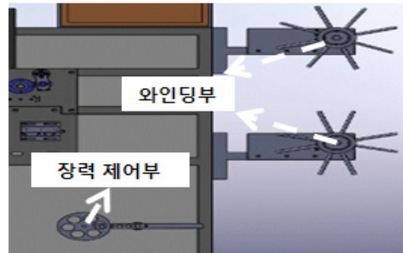
[그림 7] 권취부의 개략도 [Fig. 7] Schematic diagram of winding part
