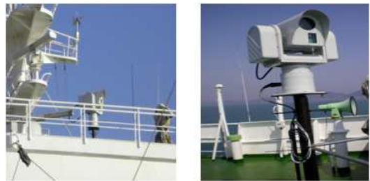
그림 7. 선박외부 팬틸트 탑재 Fig. 7. Set Pan-tilt up on compass deck
