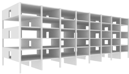
〈그림 1〉 중복도 격간벽 구조시스템
