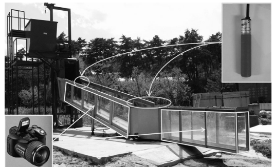
그림 5. 토석류 수리 실험 수로 및 관측 장비 (김영일과 백중철, 2011b)
