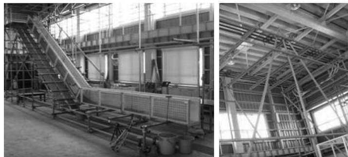
그림 2. 일본 방재과학기술연구소 토석류 수리 모형실험 (좌) 토석류 흐름 박스, (우) 인공강우 장치
