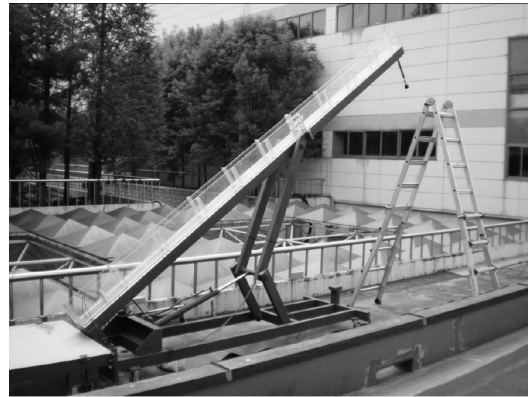
그림 4. 토석류 충격력 모의실험장치(김진환 등 2010)
