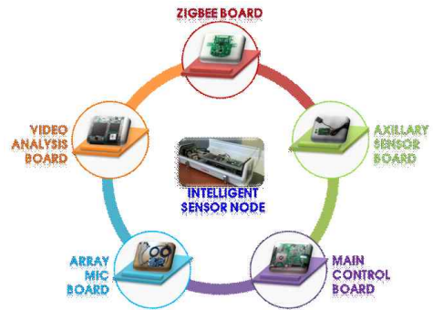
그림 3-(a) 제안된 센서노드의 구조 Fig. 3-(a) The proposed sensor node architecture
