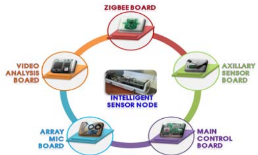
그림 3. SN module 구성도 Fig. 3. SN module composition diagram
