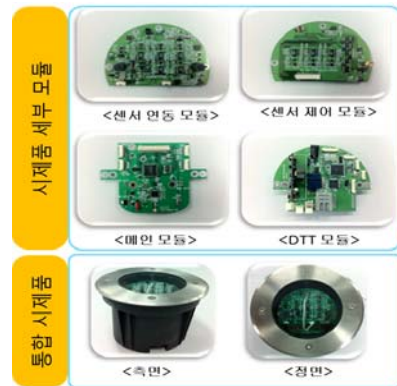
그림 10. 매립형 detection sensor node Fig. 10. Underground detection sensor node
