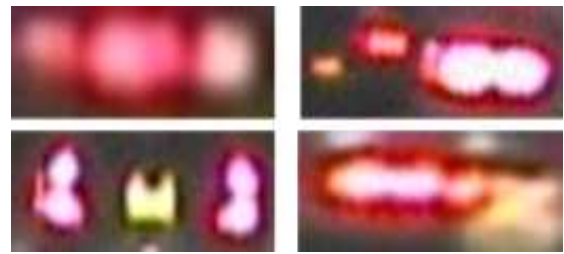
그림 9. 거리에 따른 후미등의 다양한 형태 Fig. 9. Various shapes of taillight according to different distances.
