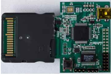
그림 4. 확장 하드웨어 어댑터 Fig. 4. The Extension Adapter
