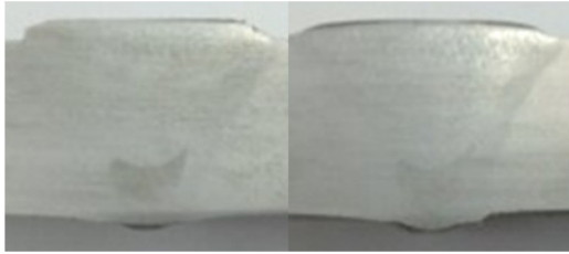
Fig. 7 Macro test(TIG+FCAW, STT+FCAW)
