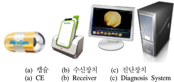
그림 1. 캡슐 내시경 시스템 구성 요소 Fig. 1. Composition of CE systems
