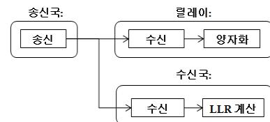
그림 3. EF 릴레이를 사용하는 통신 시스템의 BC 모드에서의 동작
