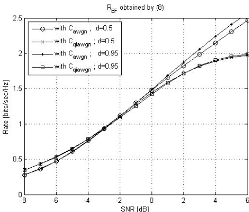
그림 9.  $d=0.95$ ,  $d=0.5$ 인 경우의 시분할 반이중 EF 릴레이의 달성 가능한 전송률 비교
