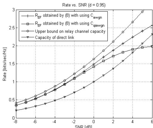
그림 8. 시분할 반이중 EF 릴레이의 달성 가능한 전송률 ( $R_{EF}$ )과 전송 용량의 비교 여기서  $R_{EF}$ 는 식 (8)을 통해 산술적으로 계산하였으며,  $d=0.95$ 로 고정하였다.
