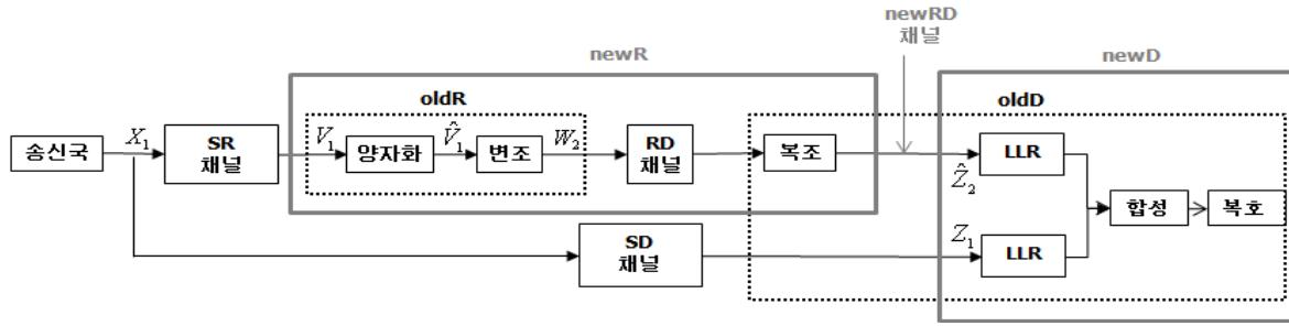
그림 5. EF 릴레이를 사용하는 통신 시스템 모델
