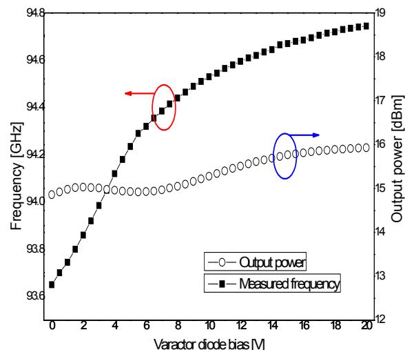
그림 5. 제작된 94 GHz 도파관 전압조정발진기의 측정결과
