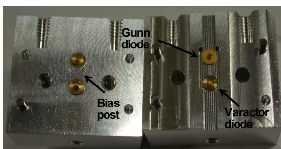
그림 4. 제작된 94 GHz 도파관 전압조정발진기
