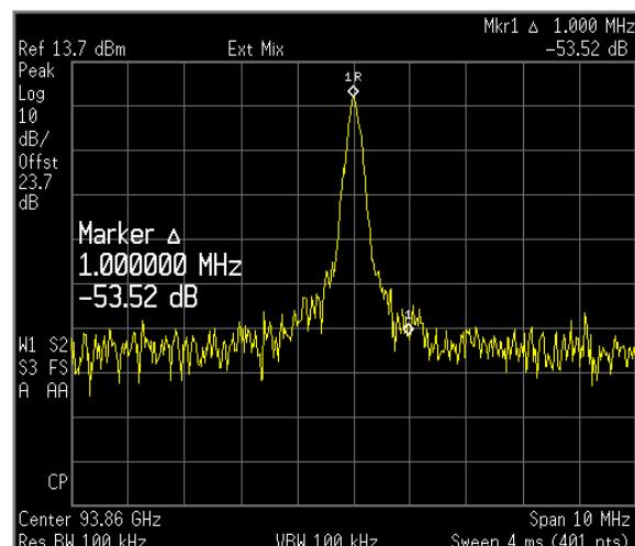
그림 6. 제작된 94 GHz 도파관 전압조정발진기의 위상 잡음 특성
