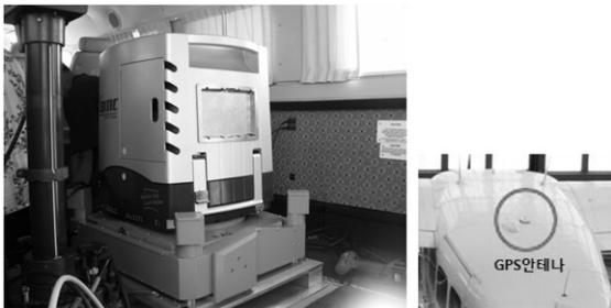
그림 4. 항공기에 설치된 DMC 항공용 카메라 설치
