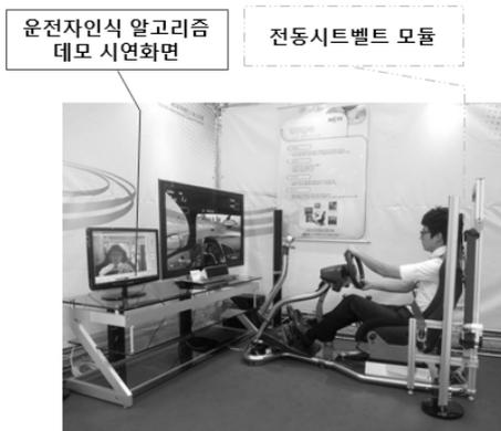
그림 9. CAN을 이용한 안전운전 보조시스템
