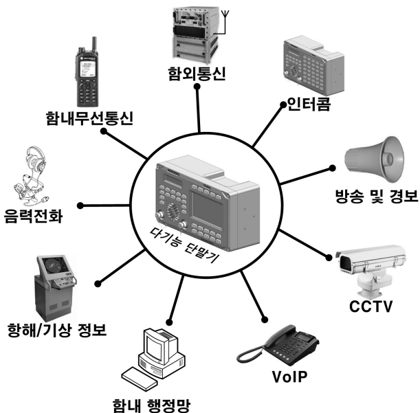
그림 1. 함정용 멀티미디어 통합통신망의 운용개념도 Fig. 1. Operational concept of integrated multimedia network for naval ship.
