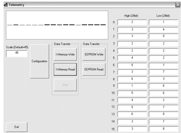
그림 12. PC와 보청기 칩 사이의 교신을 위해 휘팅 파라미터들을 PC와 보청기 칩 사이에 송수신함 Fig. 12. Fitting parameters used in DSP iC chip are transmitted and received between the DSP chip and PC.
