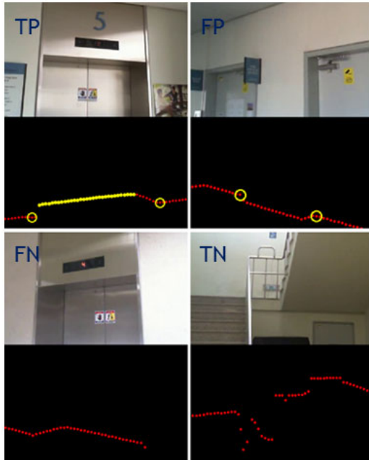
그림 11. 표 3에 대한 엘리베이터 문 감지 결과 예시. Fig. 11. Example of Table 3 for elevator door recognition.
