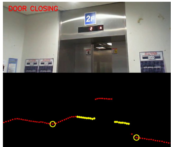
그림 8. 엘리베이터 문 감지 및 개폐 인식. Fig. 8. Elevator door recognition.
