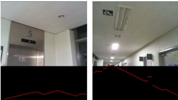
그림 4. 카메라 영상에 레이저 스캔 데이터 투영. Fig. 4. Projection laser scans on camera image.
