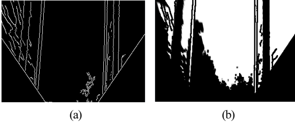
그림 5. 세그멘테이션 과정: (a) 캐니 외곽선 영상, (b) 세그먼트이션 결과 영상.
