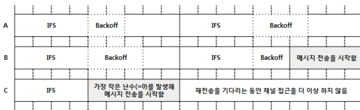
그림 1. CSMA/CA의 작동 예 Fig. 1. Example of CSMA/CA
