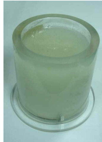
그림 5. 유방 모사 팬텀 Fig. 5. Phantom mimicking breast tissue
