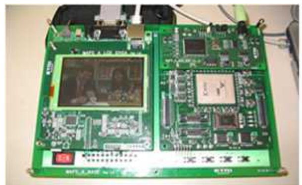
그림 16. 온칩 네트워크 H.264 디코더 FPGA 구현
