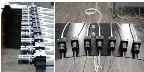
(a) 평행 배열 (b) 수렴형 배열 그림 2. 3D 촬영을 위한 카메라 배열
