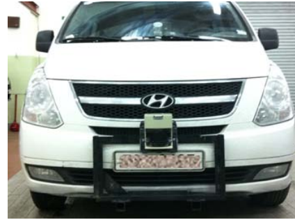
그림 8. LiDAR 센서 장착 모습. Fig. 8. LiDAR sensors installation on test vehicle.
