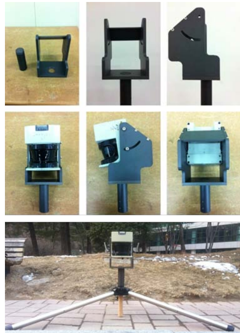
그림 6. 인프라 LiDAR 센서 거치대 설계. Fig. 6. Design of an Infra-LiDAR sensors cradle.
