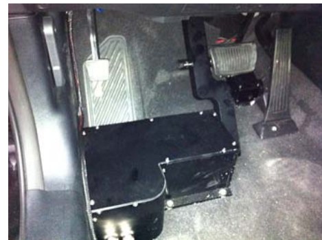
그림 9. 브레이크 페달 제어 구동부 설계. Fig. 9. Actuator design for brake control.
