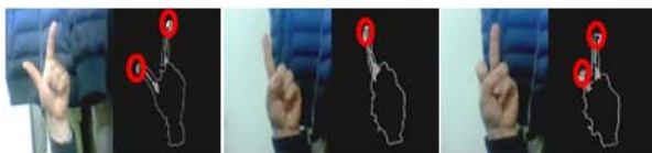
그림 6. 기울기 정보를 이용한 손가락 끝 추출 결과. Fig. 6. Curvature based fingertip extraction results.
