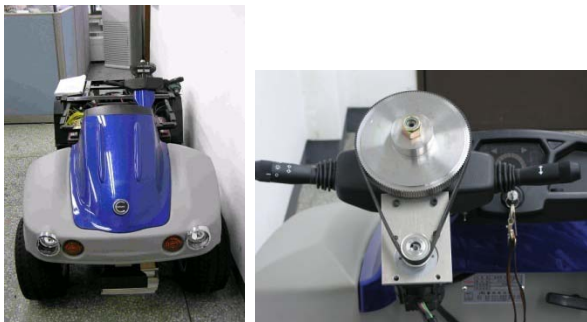
그림 1. 전기모터를 이용한 차량의 조향시스템.
