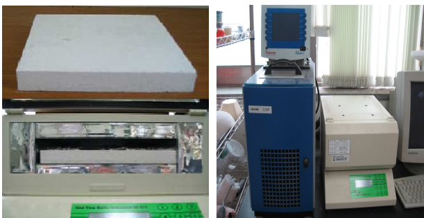
그림 2. ALC 시험편 및 열전도율 시험기
