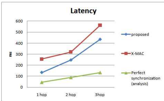
Fig 14. A Comparison of proposed MAC protocol and proposed MAC protocol latency 그림 14. 제안한 프로토콜과 X-MAC 과의 레이턴시 비교
