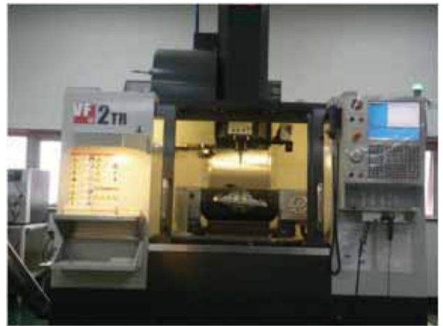
Fig. 14, 15. Intra oral scanner 에서 받은 파일을 가지고 모델을 밀링하는 모습. 재질을 우레탄으로 되어 있고 타 회사제품과 다르게 밀링을 하여서 완성한다.
