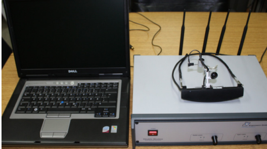
그림 2. Dikablis사의 시선추적장비 (좌: 기록장치, 우하: 수신장치, 우상: 헤드유닛) Fig. 2. Eye tracking system
