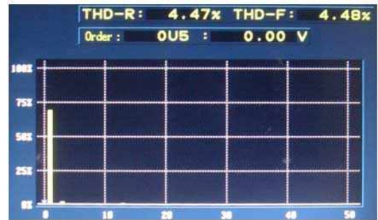
그림 13. 출력전압 THD Fig. 13 THD of output voltage
