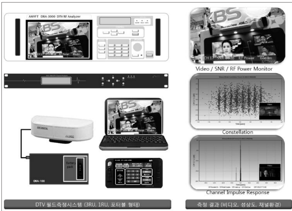
<그림 5> DTV 필드측정 시스템의 구성 및 측정결과 예시
