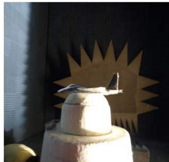
그림 4. 콤팩트 레인지(포항공대)를 이용한 측정
