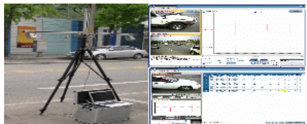
그림 1. ITS VDS 성능평가용 이동식 기준장비
