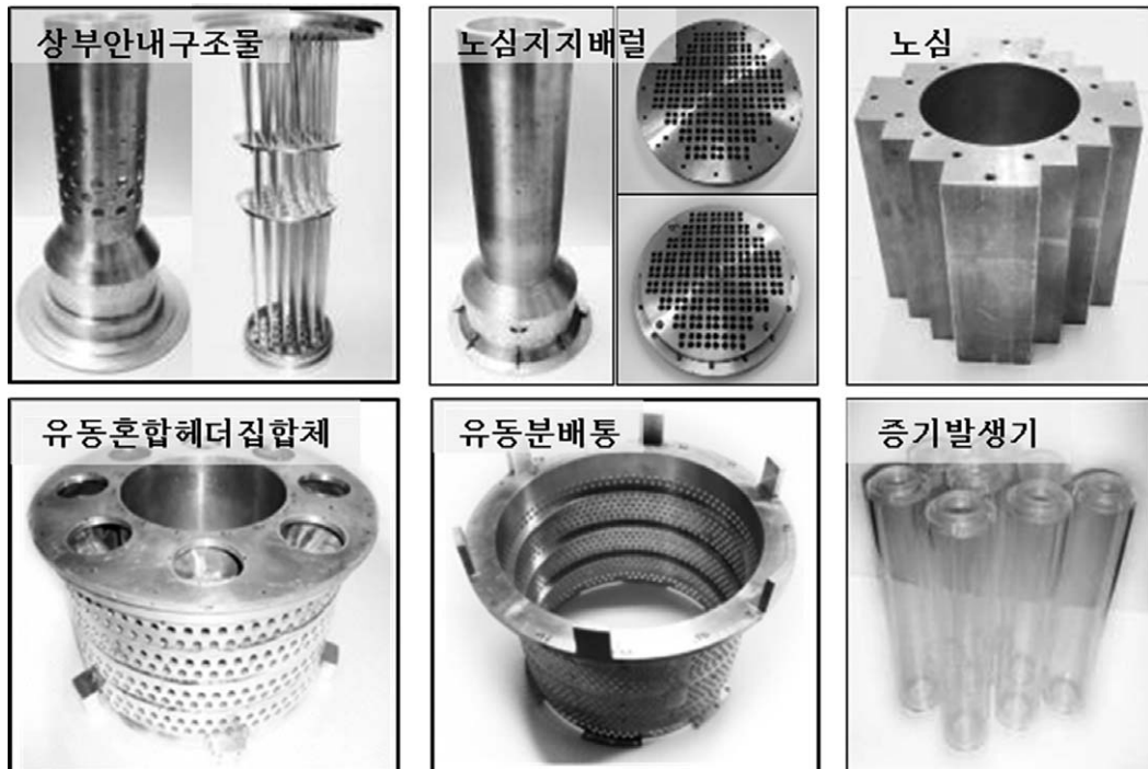
그림 2 동특성 시험을 위한 SMART 축소모형
