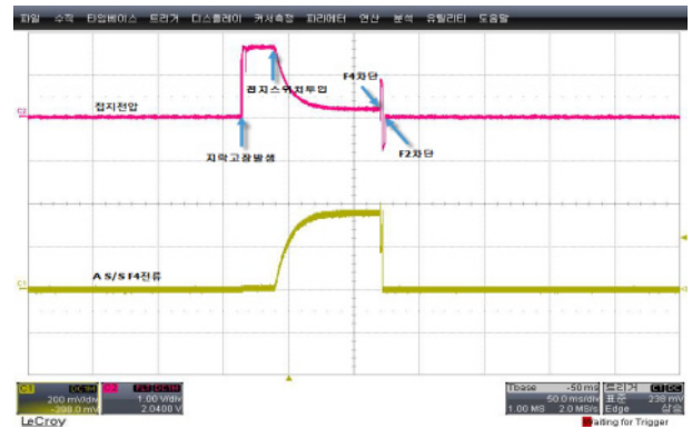
그림 13 case3 A S/S F4 전류(CH1) 및 접지전압(CH2) of A S/S in case3 Fig. 13 Current(CH1) of F4 and ground voltage(CH2) of A S/S in case3
