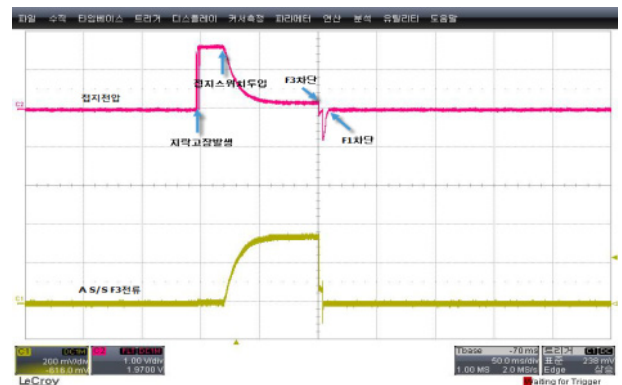
그림 15 case4 A S/S F3 전류(CH1) 및 접지전압(CH2) of A S/S in case4 Fig. 15 Current(CH1) of F3 and ground voltage(CH2) of A S/S in case4
