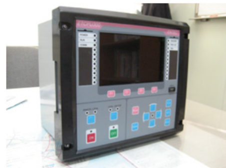
그림 7 통합보호계전기 Fig. 7 Integrated protective relay
