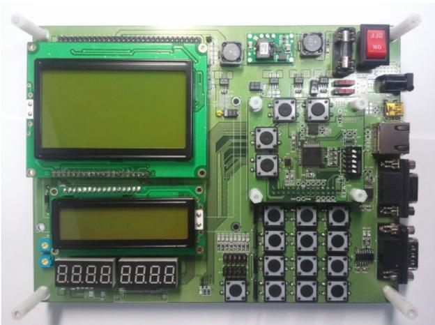
그림 8 설계한 SDAS의 PCB 기반 구현
