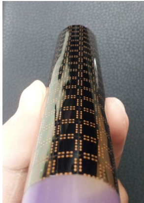
〈그림 2〉 하나마이크론이 개발한 유연한 기판에 전사된 실리콘 소자 (ZDnetkorea, 2012, 06, 07)
