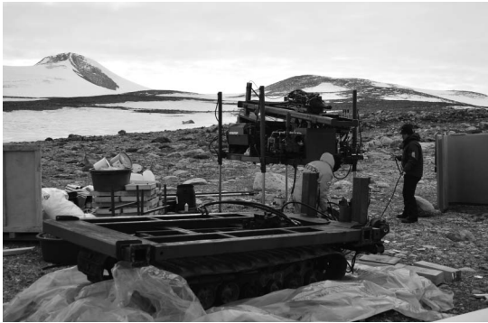
그림 3. 시추기 상부 및 하부 조립
