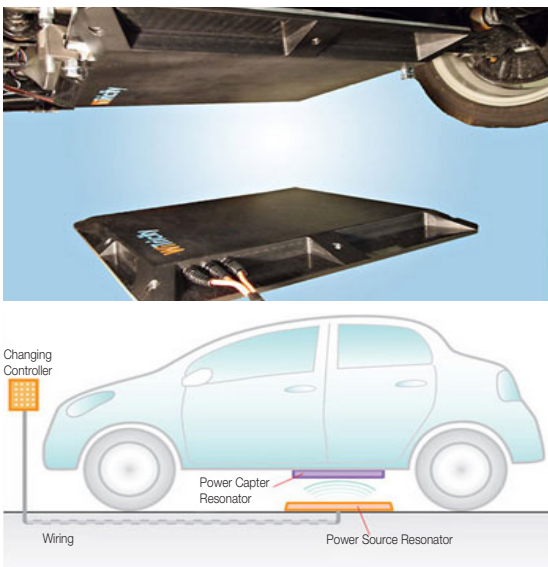
그림 6. 비접촉식 충전 Witricity's wireless charging system
