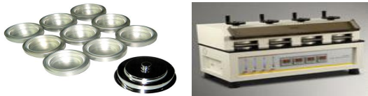
그림 10. 투습도 시험 장비
