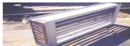
그림 12. 건조속도 시험 장비
