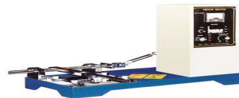
그림 4. 시험 장비 - 크로크미터
