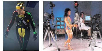
그림 2. 적외선 리플렉터 방식 Fig. 2 Infrared reflector type
