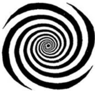
그림 2. 스파이럴 안테나 구조 Fig. 2 Structure of spiral antenna
