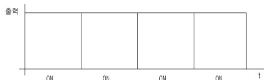
[그림 6] 설계된 DC모터 콘트롤러 회로의 최대속도 구동 출력의 도식화 [Fig. 6] The figure of the maximum power of the designed DC motor controller circuit.
