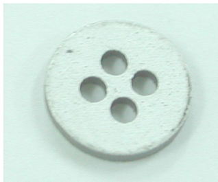
[그림 2] TO-CAN에 적합한 원형 히터 형상 [Fig. 2] Round heater shape was designed to TO-CAN
