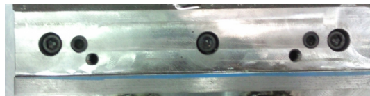
[그림 10] 자동 출력된 데이터로 홀 가공한 모습 [Fig. 10] An example of a mold manufactured according to the hole-data
