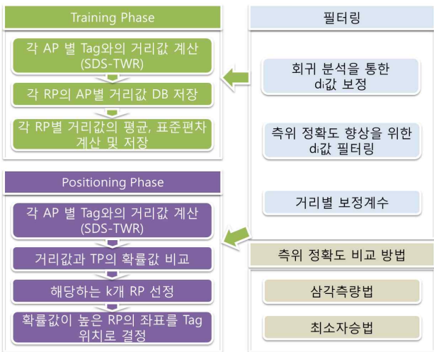
[그림 2] Fingerprint 방법과 사용된 필터링 방법
