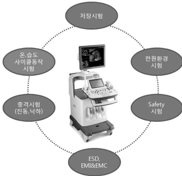
〈그림 6〉 초음파영상진단기 하드웨어 테스트
