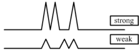
그림 2. 캡처 효과에 의한 강한 신호의 인식 Fig. 2. A reception of the stronger signal due to capture effect in case of collision.
